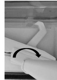
Zum Öffnen der Dachhaube müssen beide Plissees geöffnet sein. Fassen Sie die Querstange mittig und drehen Sie diese Richtung Öffnungsseite. Durch Schieben der Querstange, lässt sich die Dachhaube nun öffnen. Sobald Sie die Querstange loslassen, rastet der Ausstellmechanismus in dieser Position ein.
