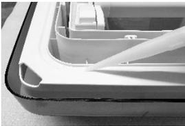
Bringen Sie das Dichtmaterial im Dichtkanal des Oberrahmens auf und setzen diesen von oben in den Dachausschnitt. **Scharnierseite in Fahrtrichtung!**
